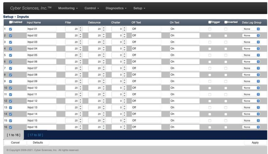
Figure 5-7. Inputs setup web page
