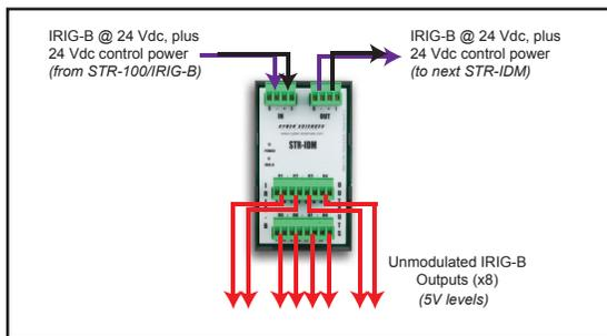
Figure 1-6. STR-IDM Inputs/Outputs
